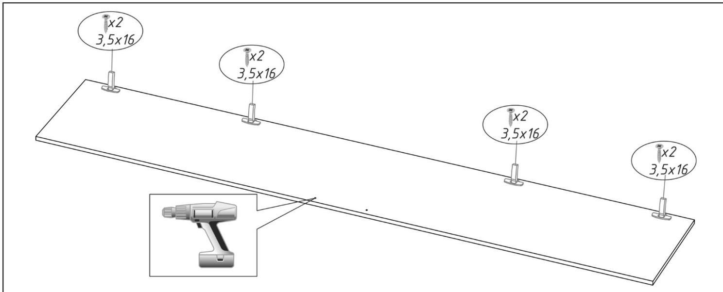
При необходимости установки ручки (приобретается отдельно) досверлить подготовленные отверстия сверлом  $\varnothing 5\text{мм}$ . В комплекте поставки вкладываются петли для монтажа которых на ответную планку (устанавливаемую в процессе сборки) не требуется инструмент. Регулировка фасада по горизонтали и вертикале производится регулировочными винтами интегрированными в петли.
