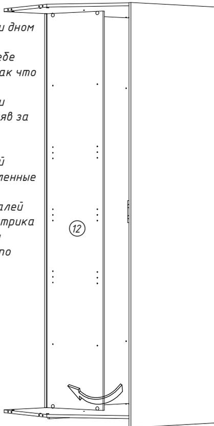
Следующий шаг, монтаж Горизонтов (больших полок). Заведите в пространство между собранными деталями №5,6,7,12 детали №9 (2 шт) таким образом чтобы они были выше штоков эксцентриков №6 и опустите их вниз. Затем требуется закрыть замки эксцентриков поворотом отверткой по часовой стрелке головки эксцентрика.
